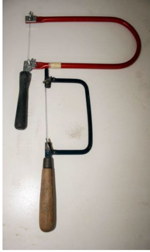
Fotoğraf 20: Sedef kakma yapımında kullanılan kıl testereler
