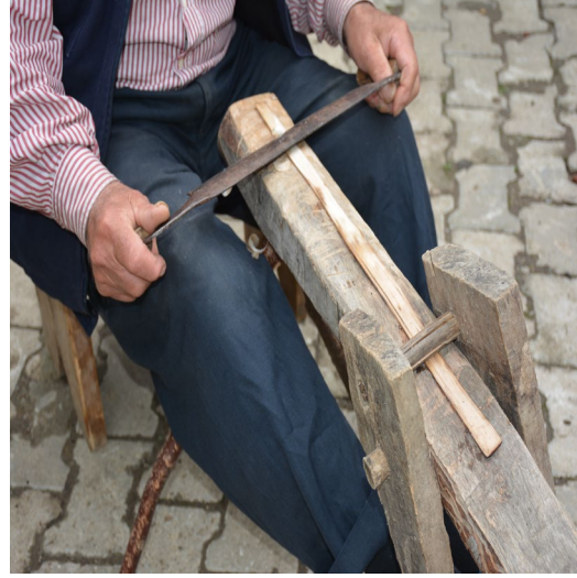
Fotoğraf 2: Fındık dalları 3-4 eşit parçaya bölündükten sonra bu parçalar yontularak düzleştirilerek örmeye hazır vaziyete getirilir.
